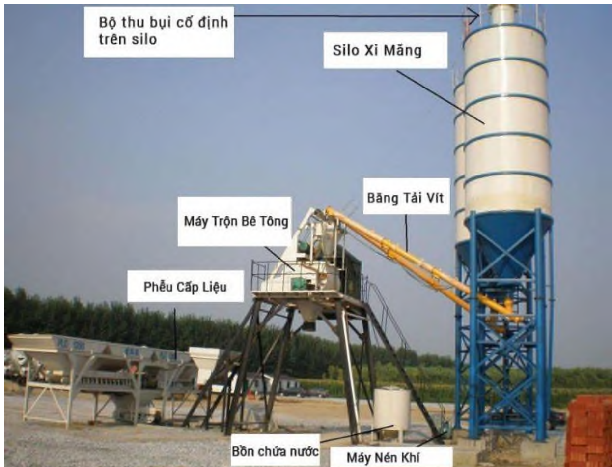
Hình 1.6. Cấu tạo trạm trộn bê tông thương phẩm
