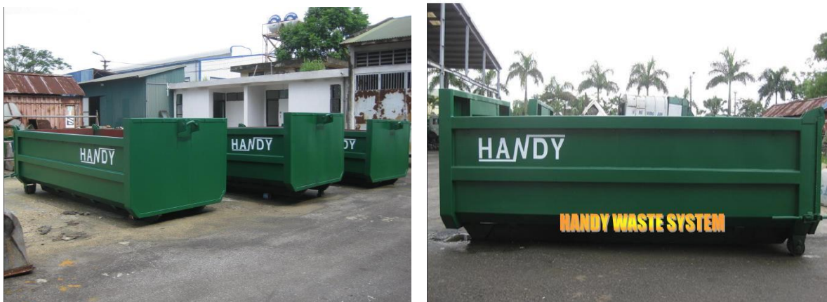
Hình 29. Hình ảnh thùng ben chứa phế thải xây dựng 5 m 3 tại công trường thi công dự án
