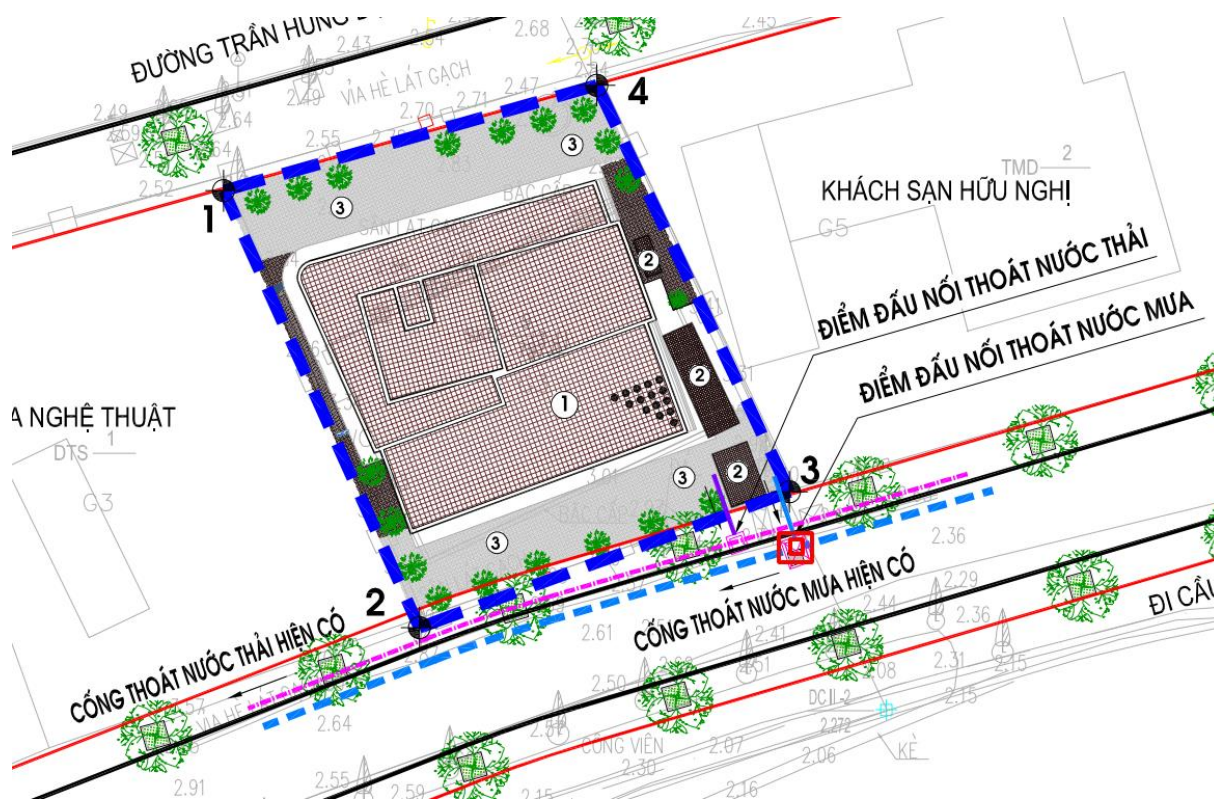
Hình 20. Điểm đầu nối thoát nước mưa từ dự án ra tuyến cống thoát nước mưa chung của khu vực
