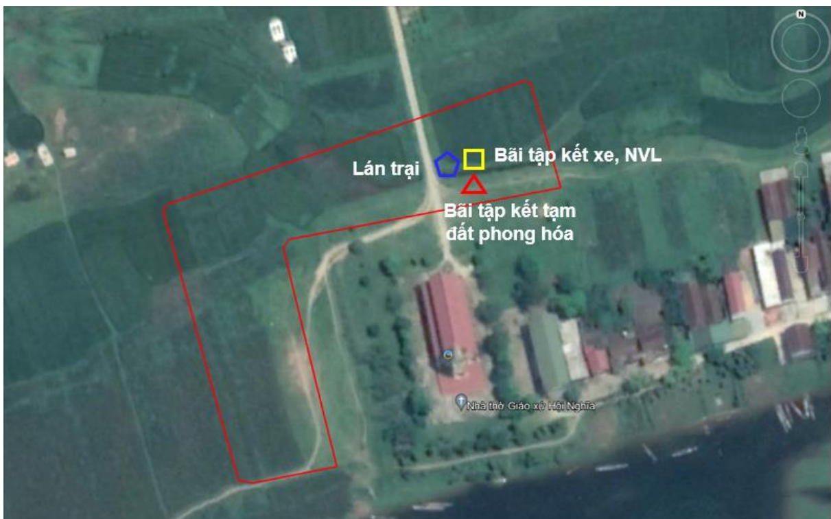
Hình 2. Vị trí dự kiến đặt lán trại, tập kết xe, NVL và tập kết tạm đất phong hóa
