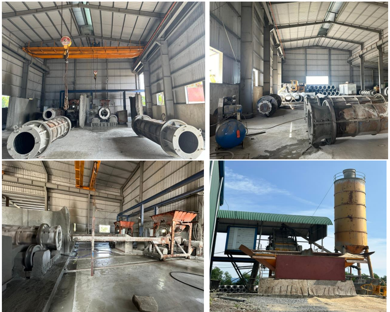
Hình 2. Khu vực nhà xưởng sản xuất cấu kiện bê tông ly tâm
