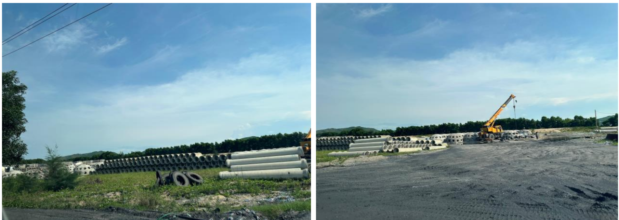
Hình 4. Khu vực cho thuê bãi sản xuất cấu kiện bê tông đúc sẵn ngoài trời
