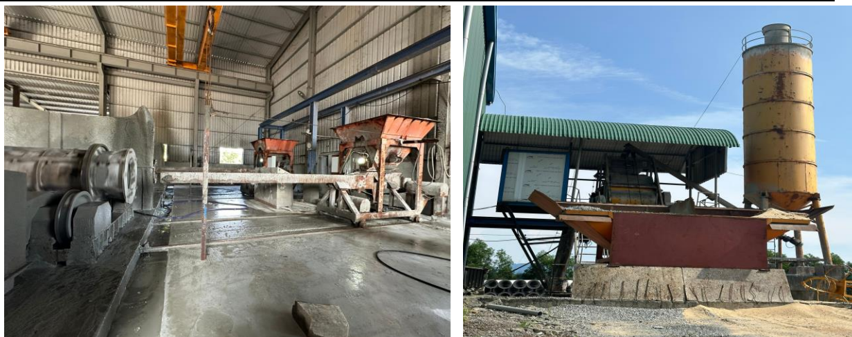
Hình 2. Khu vực nhà xưởng sản xuất cầu kiện bê tông ly tâm
