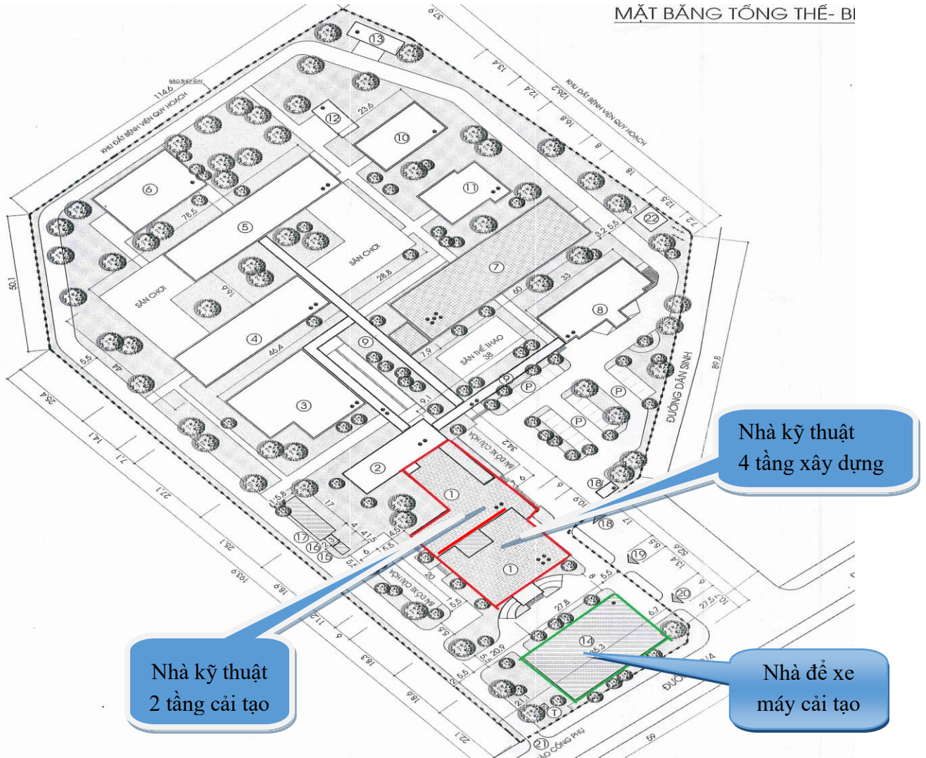
Hình 2. Mặt bằng định vị hạng mục công trình cải tạo, mở rộng của cơ sở
