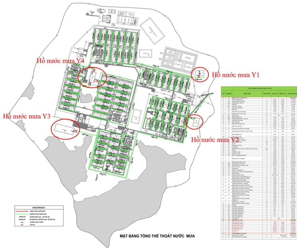
Hình 3-1: Mặt bằng tổng thể thoát nước mưa
