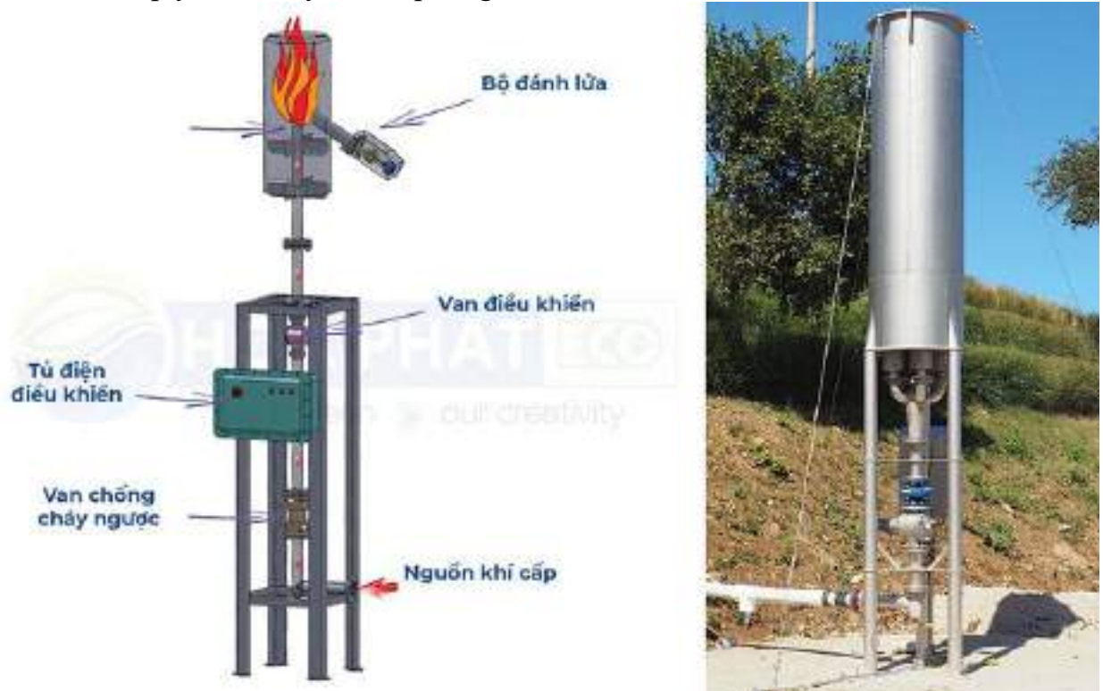
Hình 4.2. Thiết bị đầu đốt khí Biogas
