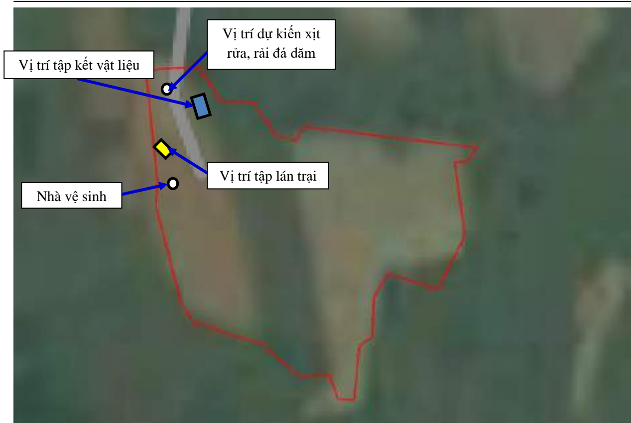
Hình 1.6. Bố trí các hạng mục phụ trợ giai đoạn xây dựng dự án
