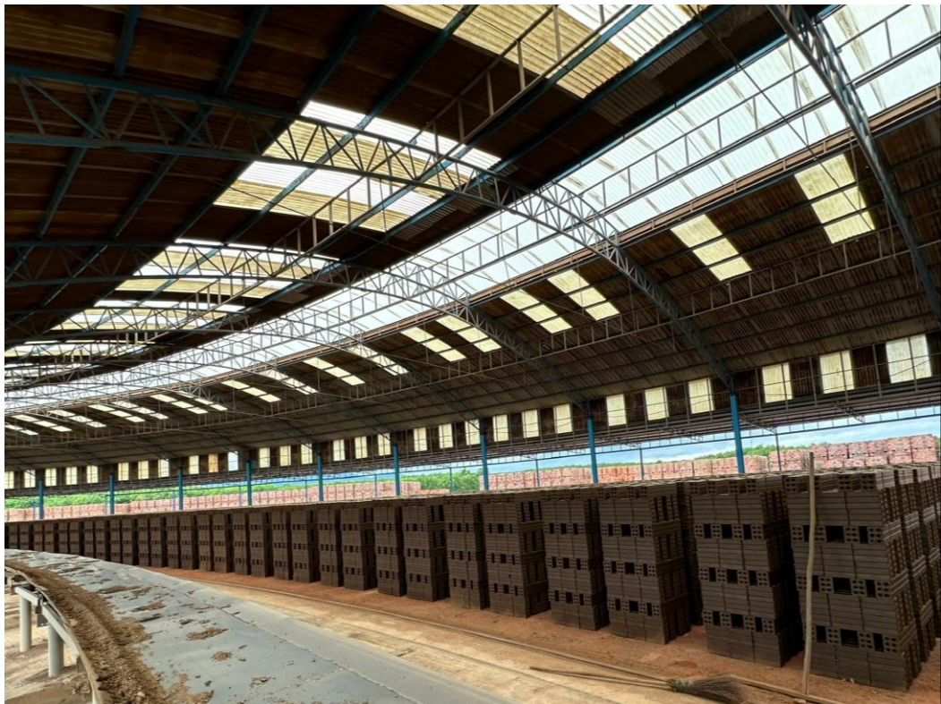
Hình 6. Công đoạn phơi, sấy bán thành phẩm
