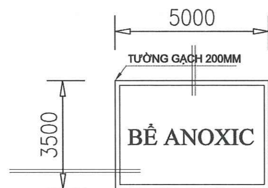
MẶT BẰNG BỂ ANOXIC
